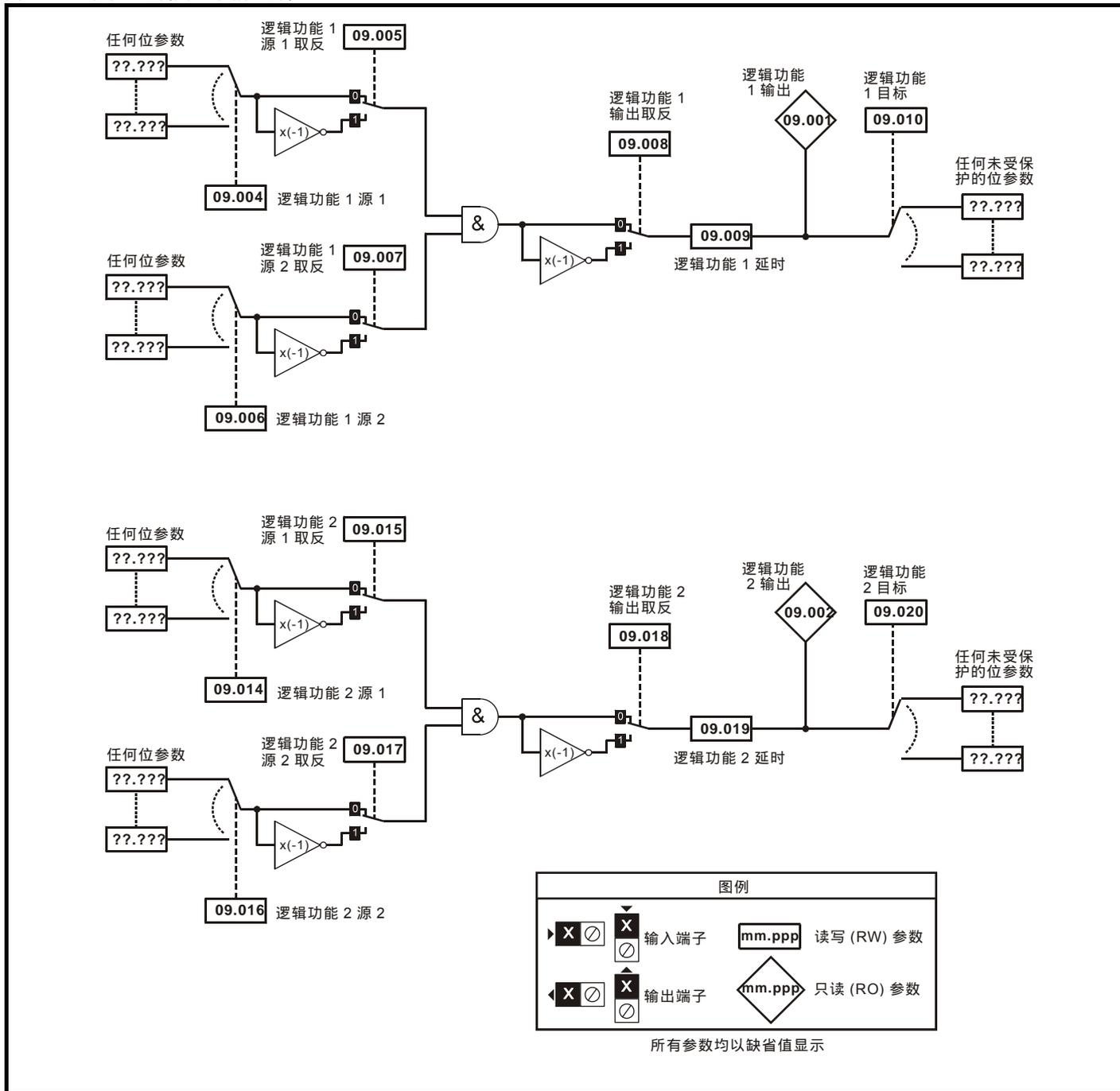
图 11-21 菜单 9 逻辑图：电动电位器和二进制和
