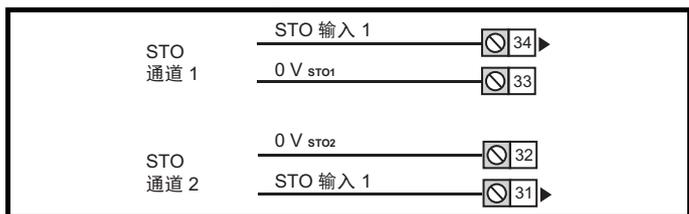
图 4-5 安全转矩关闭输入 (5 至 9 型)
