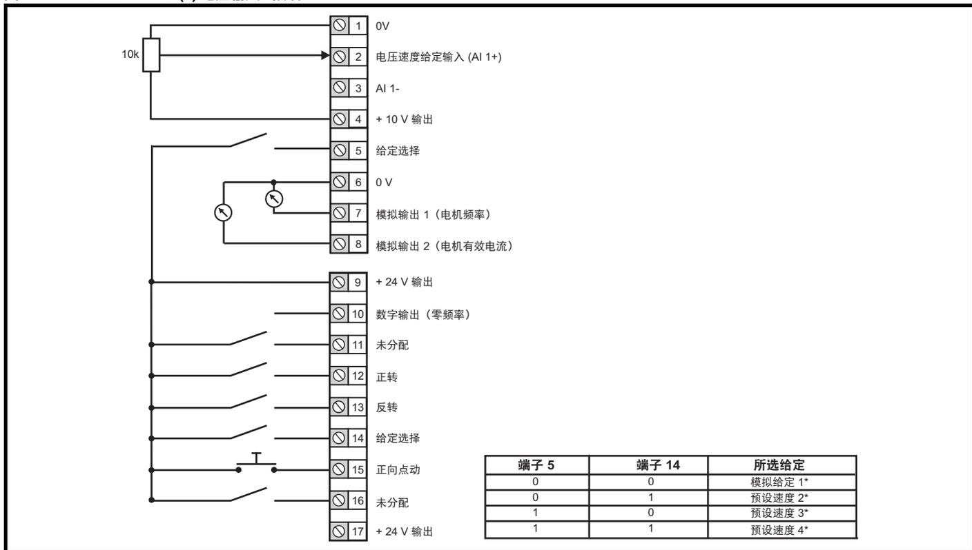
图 6-5 Pr 00.005 = AI.Pr(3) 电流输入 . 预设
