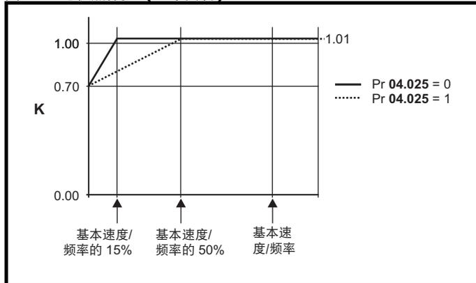
Pr **04.025** 的两种设置均用于电机风机的风冷效果随电机速度的降低而降低、但不同速度下风冷效果的降低程度不同的电机。若 Pr **04.025** 为 0，则该特性用于风冷效果随低于基本速度 / 频率 15% 的电机速度的降低而降低的电机。若 Pr **04.025** 为 1，则该特性用于风冷效果随低于基本速度 / 频率 50% 的电机速度的降低而降低的电机。K1 的最大值为 1.01，因此，高于该特性的基准，电机可以高达 101% 的电流持续运行。
