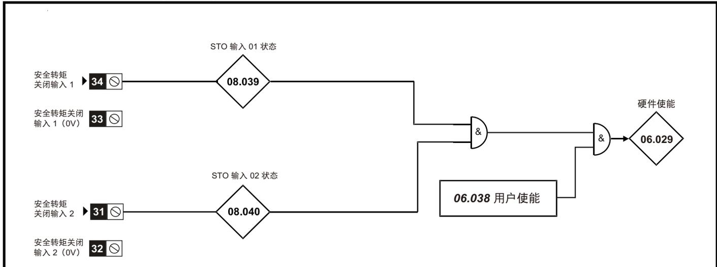
图 11-17 安全转矩关闭逻辑图 (5 至 9 型)
