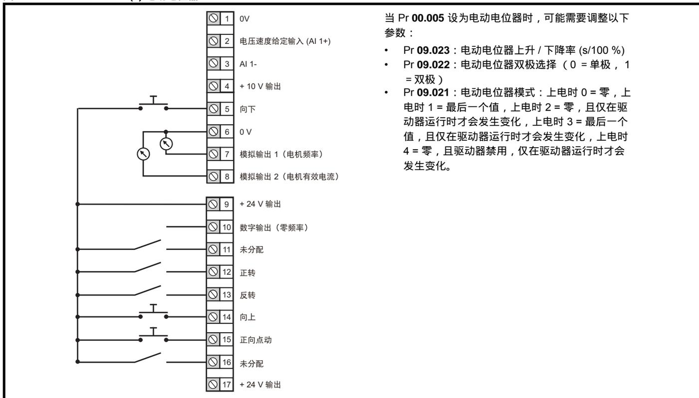
图 6-10 Pr 00.005 = torque(8) 转矩
