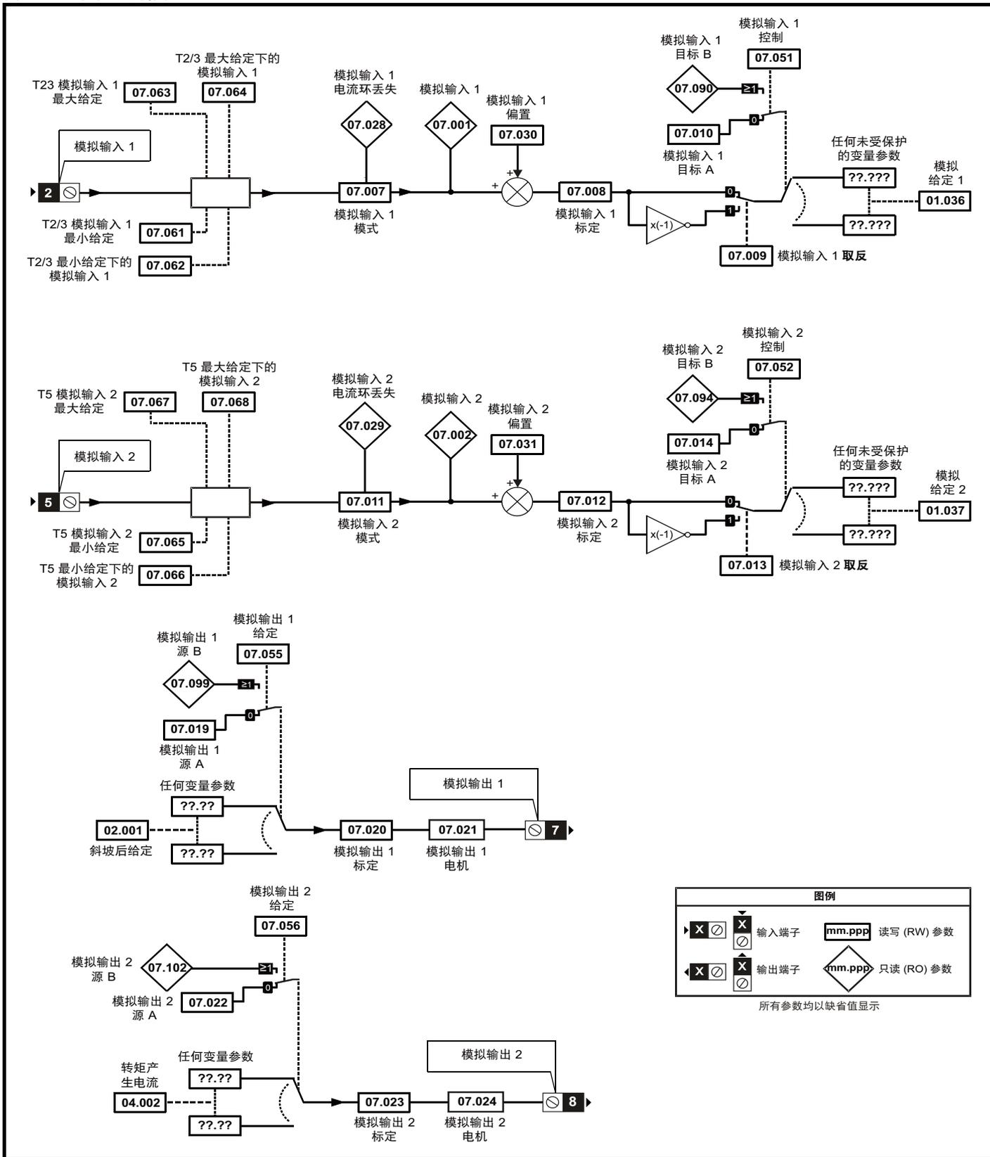
图 11-12 菜单 7 逻辑图：热敏电阻输入
