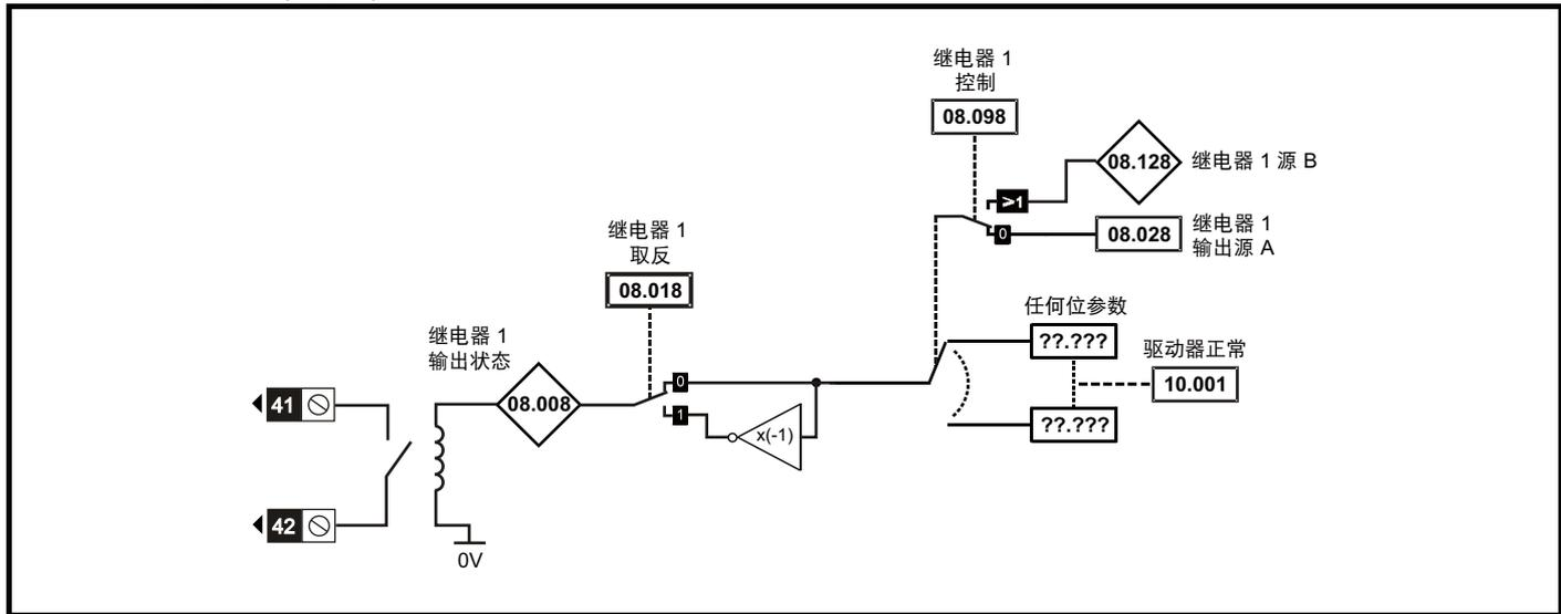
图 11-16 安全转矩关闭逻辑图 (1 至 4 型)
