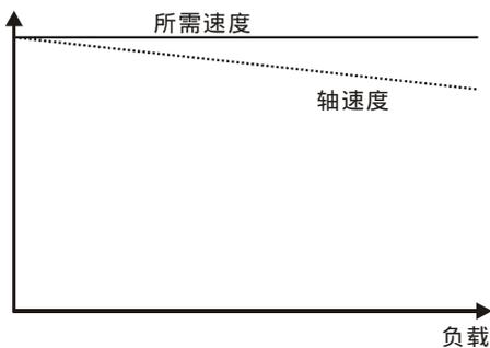
为了防止如上所示的速度降低，应启用滑差补偿。若要启用滑差补偿，必须将 Pr 05.027 设为 100%（这是默认设置），并将电机额定速度输入 Pr 00.007 (Pr 05.008) 中。
