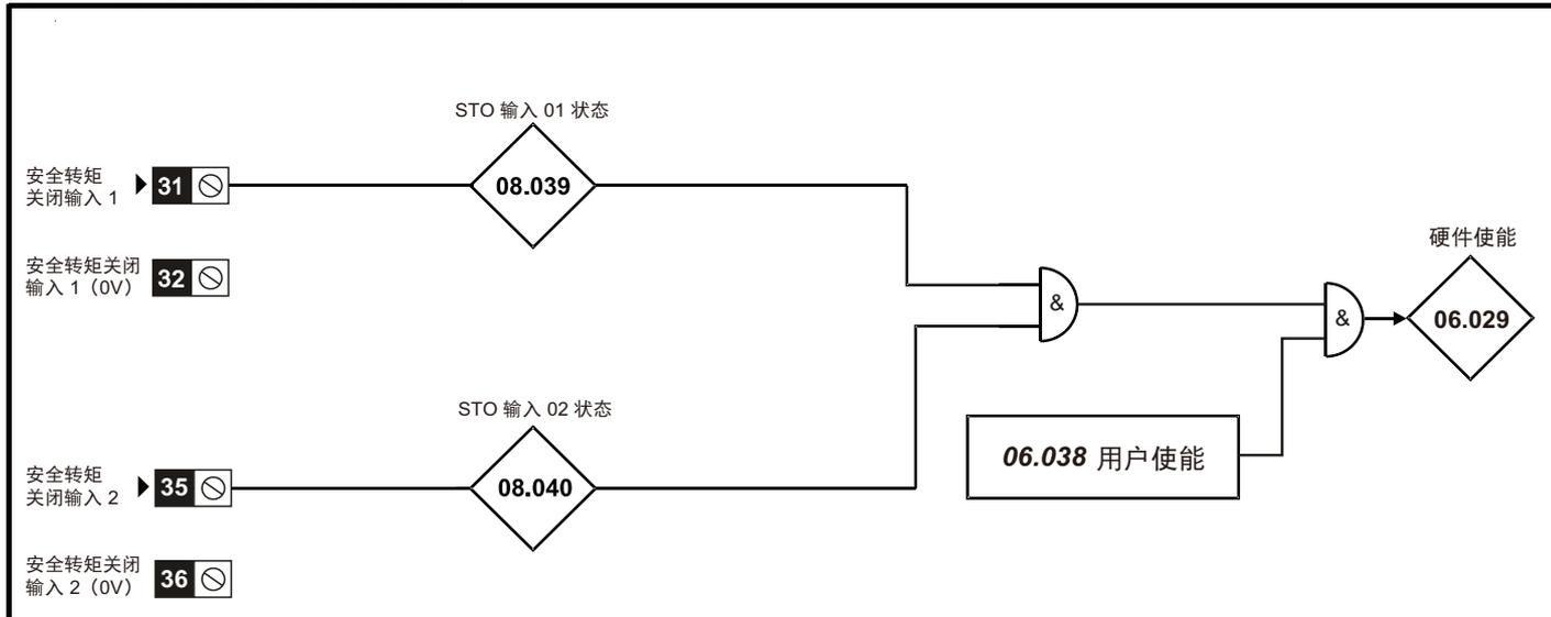
图 11-18 菜单 8 逻辑图 (远程键盘 RTC)
