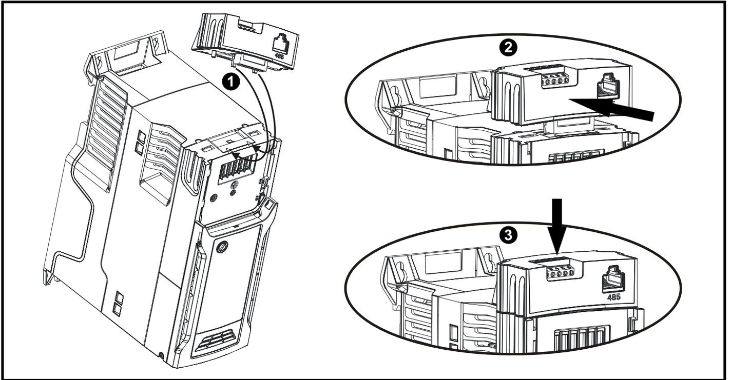
1. 找到 AI-485 / AI-Backup 适配器底部的两个塑料指套 (1) - 然后将两个指套插入驱动器顶部弹簧加压滑盖内的相应插槽。
