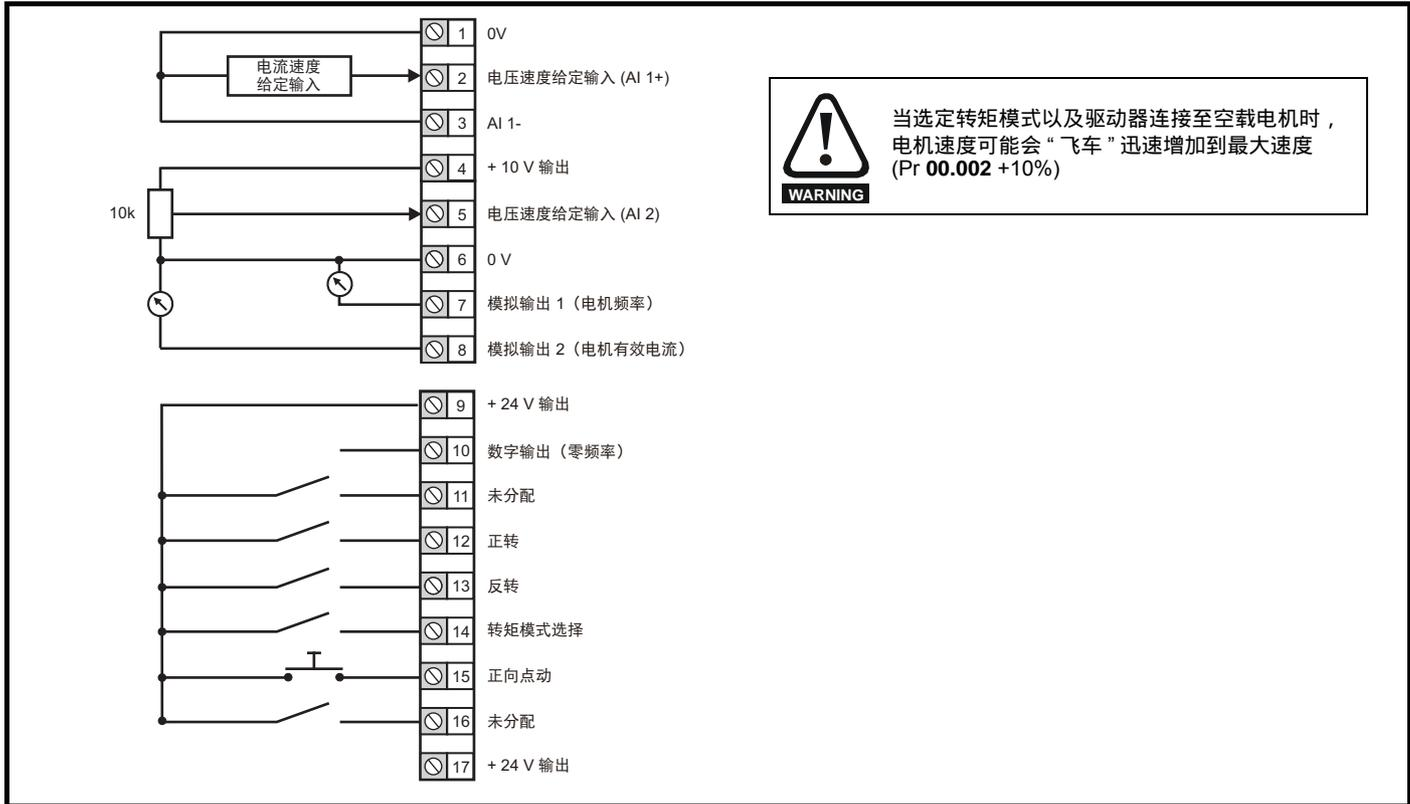
图 6-11 Pr 00.005 = Pid(9) 闭环调节
