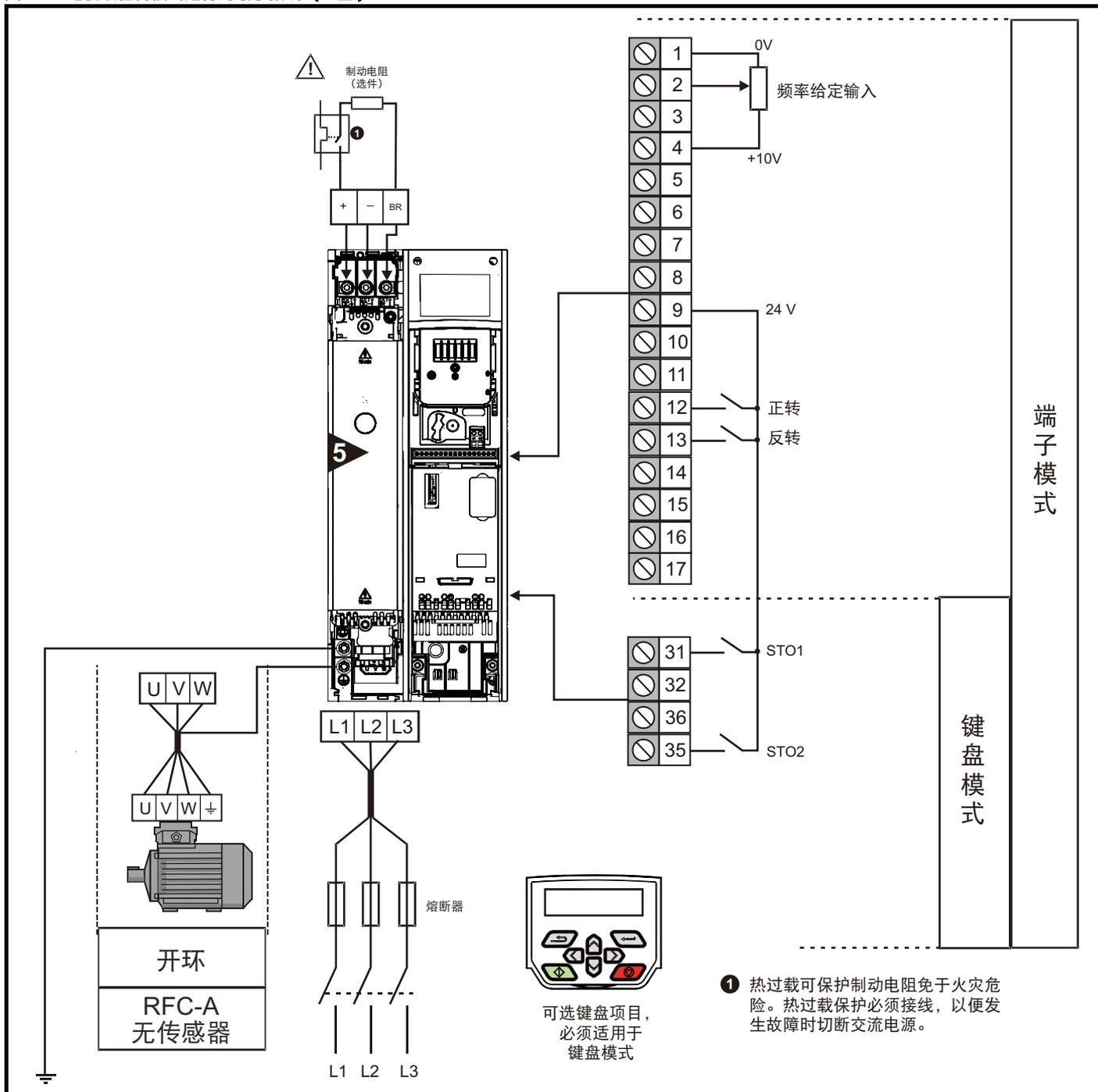
图 7-3 电机以任何模式运行的最小接线 (6 型)
