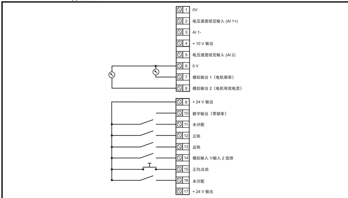
图 6-9 Pr 00.005 = E.Pot(7) 电动电位器
