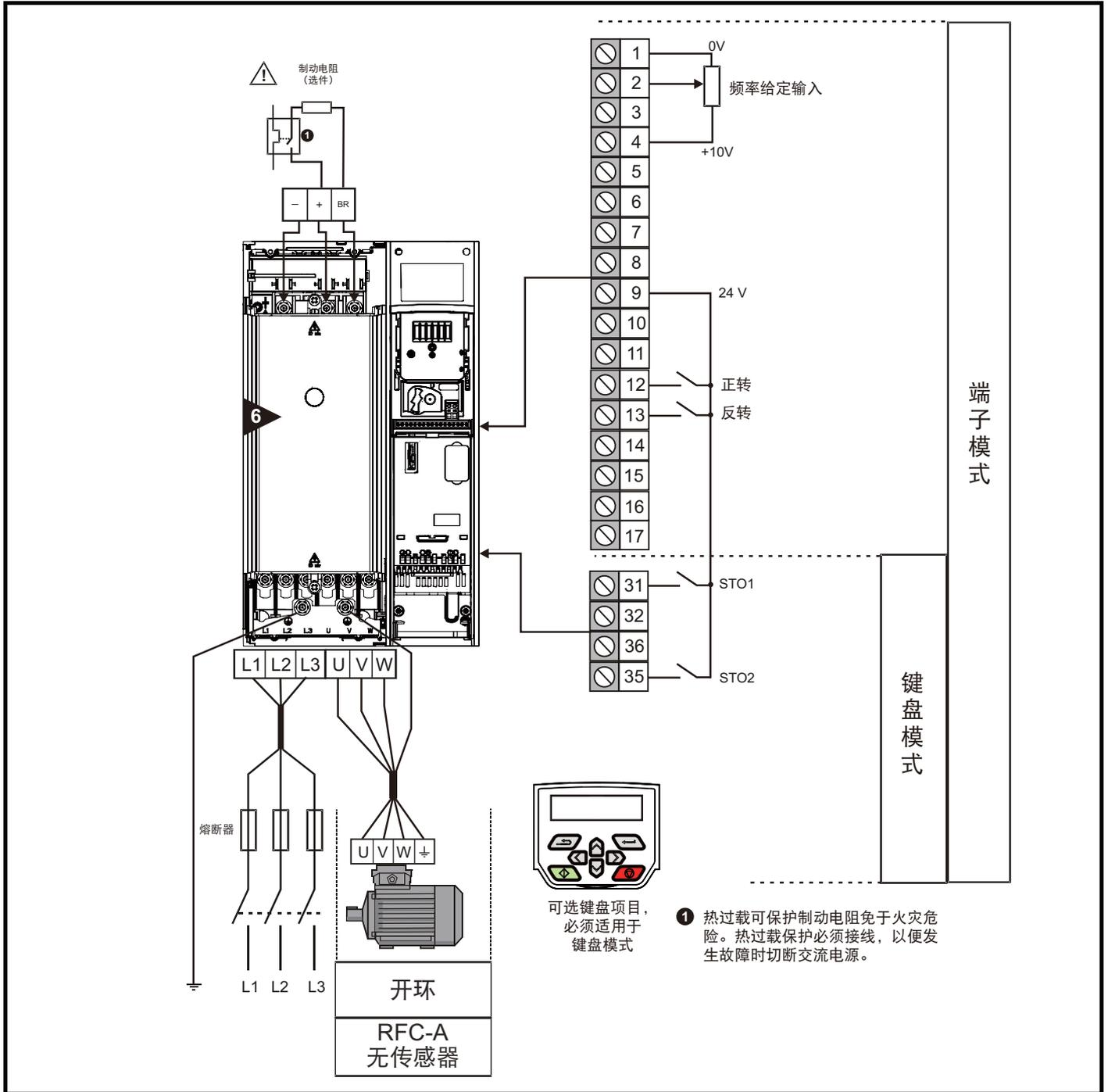
图 7-4 电机以任何模式运行的最小接线（7 型及以上）
