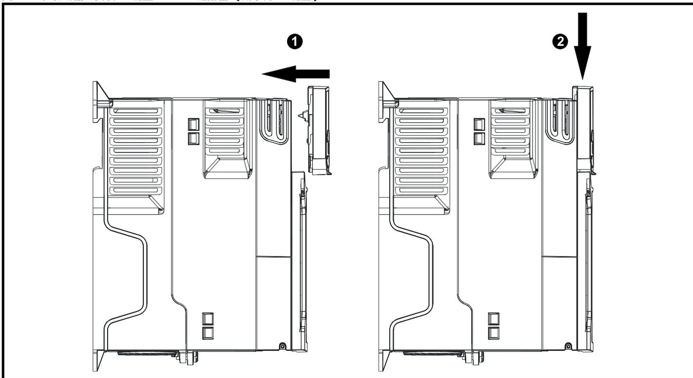
如需拆除 CI 键盘 / CI-485 适配器，如图 3-7 所示反向执行安装过程即可。
