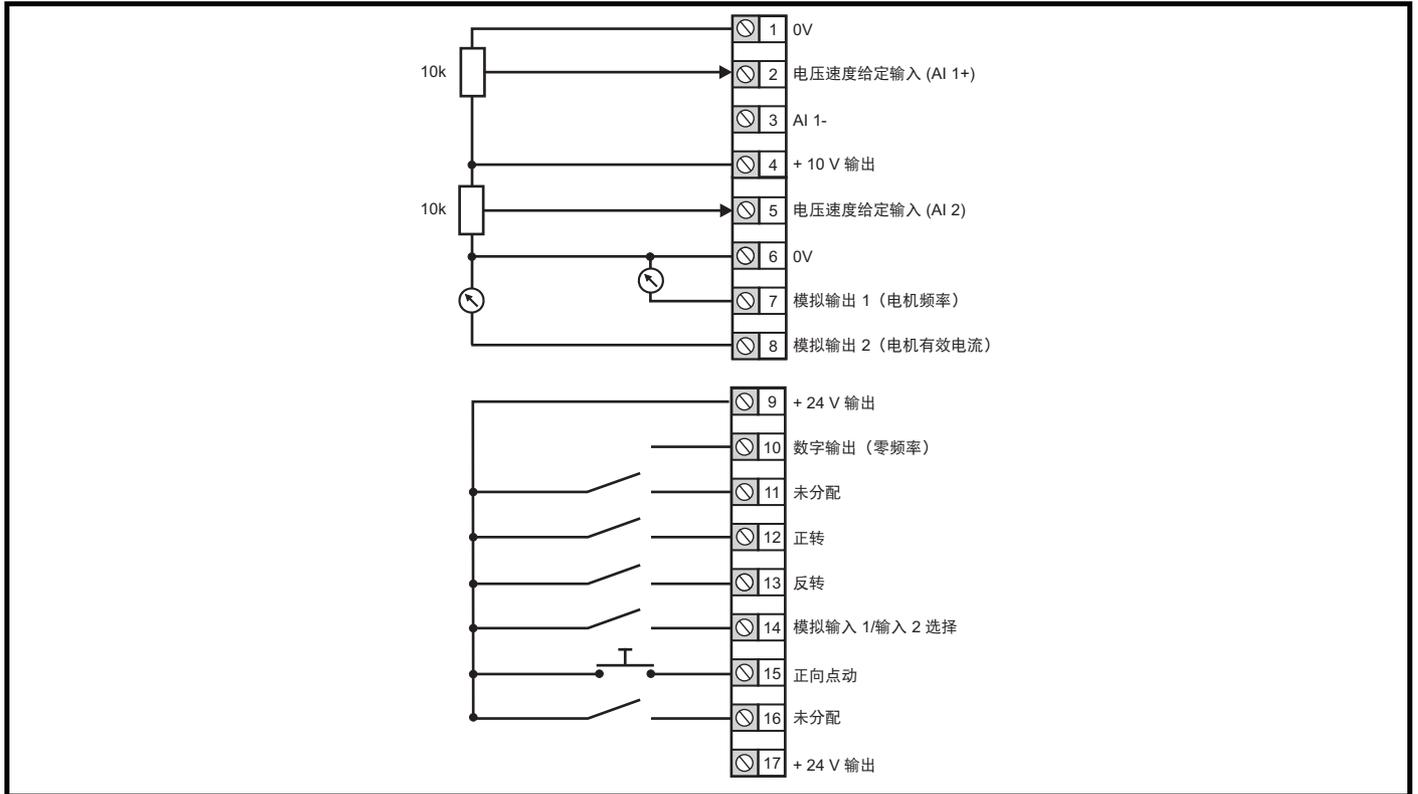
图 6-3 Pr 00.005 = AI(1) 电流输入
