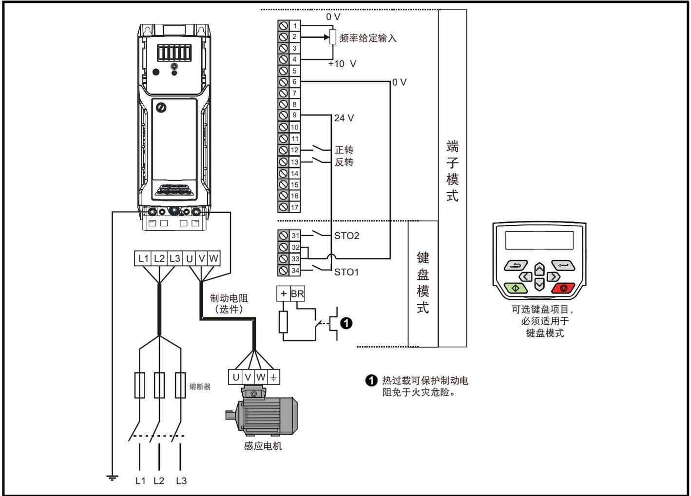
图 7-2 电机以任何模式运行的最小接线 (5 型)
