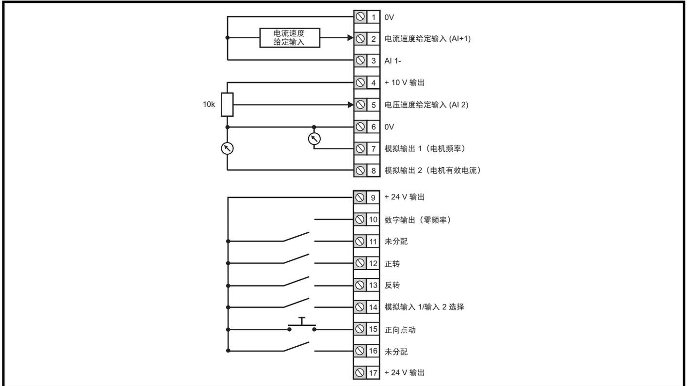
图 6-4 Pr 00.005 = AV.Pr(2) 电压输入 . 预设
